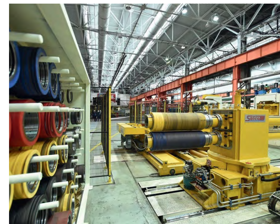
Кировский завод ОЦМ. Линия фрезерования полосы в рулонах с заточным станком MINO.
